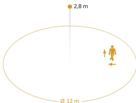
Possibile altezza di montaggio: 2,50 m – 4,00 m
